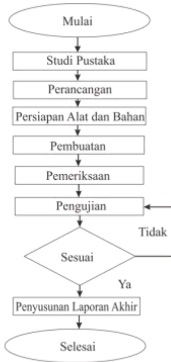
Gambar 1. Tahapan pelaksanaan pembuatan sensor parkir
