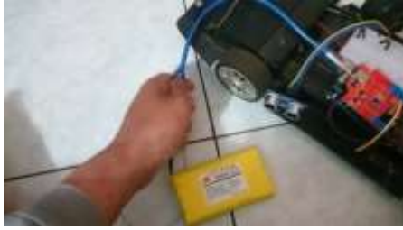
Gambar 9. Pemasangan Catu Daya
