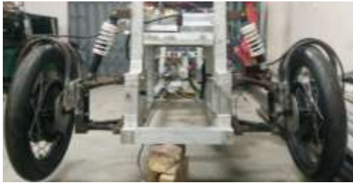
Gambar 6. Dua buah sistem pemindah tenaga model direct drive transmission .
