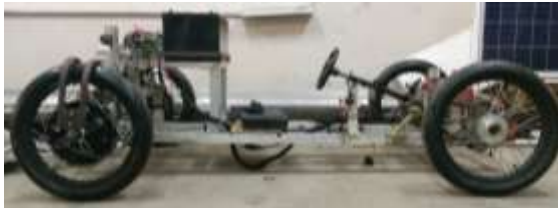
Gambar 7. Mobil listrik type urban dengan sistem pemindah tenaga direct drive transmission
