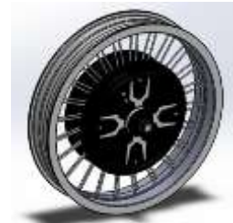
Gambar 2. Desain konstruksi direct drive transmission .
