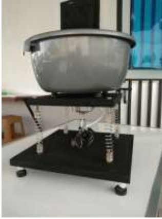
Gambar 2. Alat getar penghilang karat
