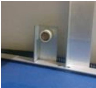
Gambar 8. Pemasangan sensor LDR
