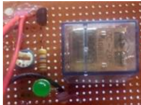
Gambar 2. Hasil rangkaian sensor LDR
