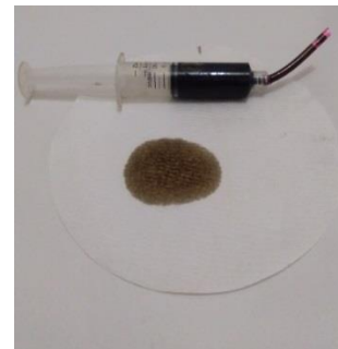
Gambar 5. Hasil warna oli selama 21-42 jam
