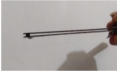
Gambar 6. Hasil uji kekentalan oli selama 21-42 jam
