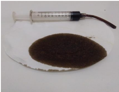
Gambar 7. Hasil warna oli selama 42-63 jam
