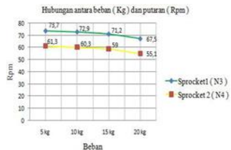
Gambar 2. Grafik hubungan antara beban dengan putaran transmisi rantai pada kapasitas 20 kg
