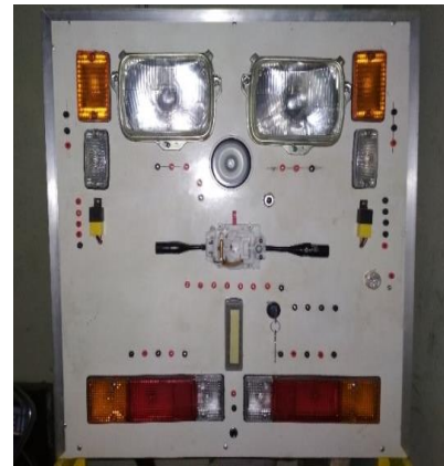
Gambar 3. Rangkaian kelistrikan lampu
