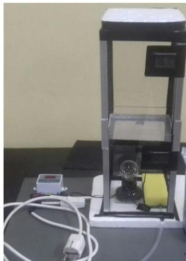
Gambar 1. Alat uji pengkondisian udara menggunakan silika gel
