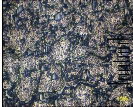
Gambar 2. Struktur Mikro Variasi 0% Cu dengan Perbesaran 100 Kali
