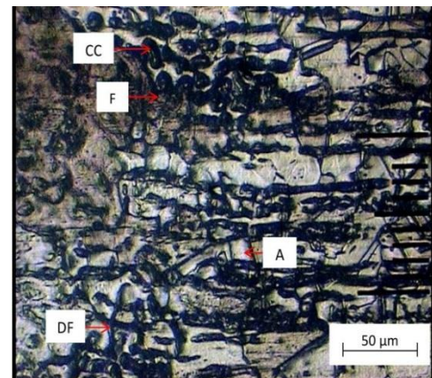
Gambar 16. HAZ heat input 3,95 kJ/mm
