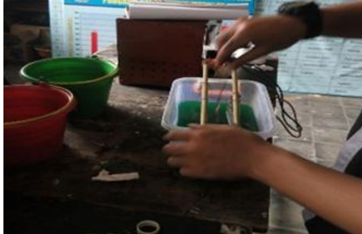
Gambar 3. Penggantungan benda kerja ke rectifier (Sumber Dokumentasi)
